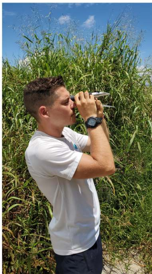
Figure 10. Mesure de la salinité de l'eau.
